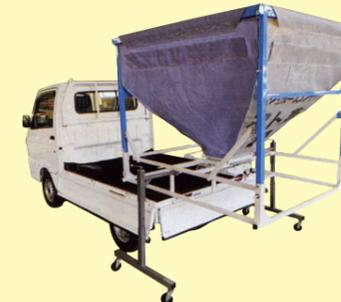
移動やトラックへの積み下ろしがラクにでき、収納時には本体を回転させコンパクトに収納できます。
